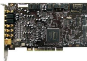
(suoni) da inviare ad altoparlanti o cuffie. Inoltre può generalmente lavorare in senso inverso, e ricevere segnali audio in input (ingresso) da microfoni o strumenti musicali e convertirli in files audio.
